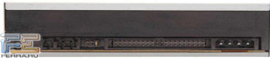
Рис.4. Интерфейс Parallel ATA
